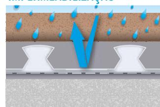
A camada contínua de PEAD garante imediatamente a estanquidade hidráulica.
