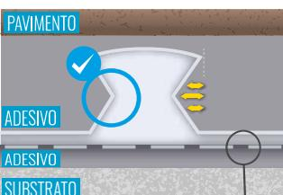
A conceção exclusiva da estrutura tridimensional da camada de PEAD permite fixar valores recorde de aderência.
