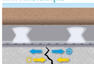
A estrutura tridimensional do STRATA\_MAT™ WP isola completamente o pavimento dos movimentos do substrato.
