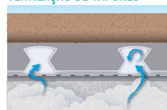
O vapor gerado pela humidade residual excessiva no substrato libera a pressão em cavidades ocas.
